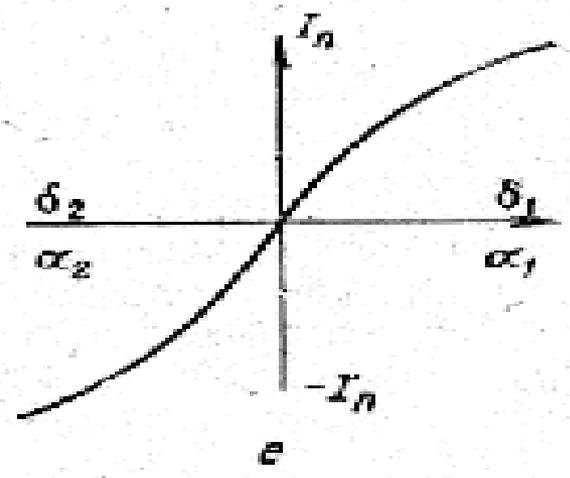
**1- расм. Индуктив ва трансформатор датчикларининг схемалари ва уларнинг тавсифномалари**
