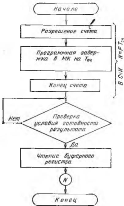
новешивание») (рис. 5.26). Результат ПП ПЧК — текущее значение кода на выходе счетчика  $N = FT_{сч}$ , а ПП «Уравновешивание» — определение и запись во входной регистр ЦАП значения кода  $N_{свч}$ , соответствующего мощности постоянного тока  $P_0$  при реальных параметрах окружающей среды. Подпрограмма «Установка 0» обеспечивает адаптивное управление прибором.
