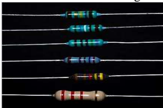
6.1-rasm. Har xil nominalli rang belgisi yordamida oltita rezistorni sxemasi
