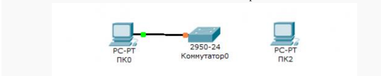
14.9-rasm. PC0 va kommutator0 to`g`ri mis kabel bilan ulash
