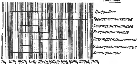
Рис. 13.3. Частотный диапазон применения вольтметров различных систем для измерения переменного напряжения.
