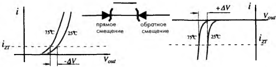
Рис. 5.18. Температурная компенсация стабилитронов
