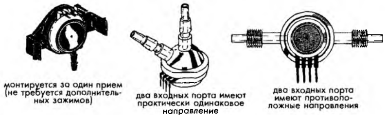
Рис. 10.8. Примеры корпусов дифференциальных датчиков давления. (Напечатано с разрешения Motorola Inc)
