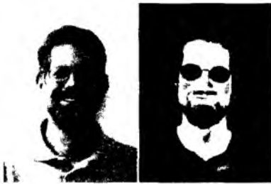
Рис. 3.47. Фотографии в видимом свете и в ИК излучении. Отметим, что более яркие области (кажущиеся более теплыми) в складках кожи возле носа объясняются резонансным эффектом. Очки на ИК фотографии выглядят черными (холодными), поскольку стекло не пропускает лучи среднего и дальнего ИК диапазона и, следовательно, задерживает тепловое и злучение от лица. (Фотографии напечатаны с разрешения Infrared Training Center, www.infraredtraining.com )
