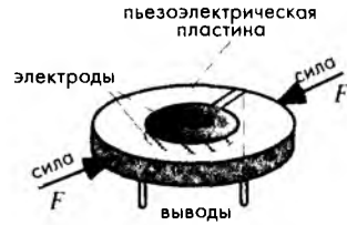
Рис. 9.12. Пьезоэлектрический дисковый резонатор, применяемый в диаметральном датчике силы
