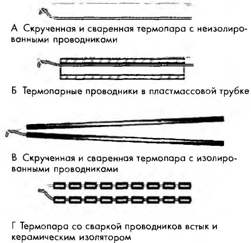
Рис. 16.18. Некоторые типы термопарных сборок
