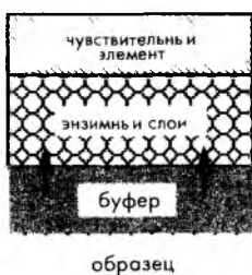
Рис. 17.15. Схема энзимного детектора
