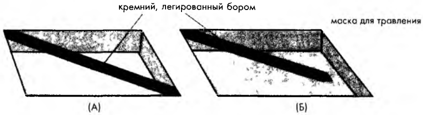
Рис. 18.14. Изготовление методом травления мостовых и консольных структур
