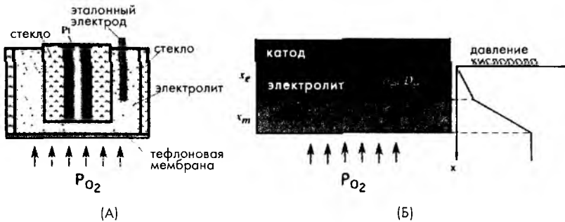
Рис. 17.7. Схема элемента Кларка (А) и одномерная модель первого порядка распределения давления кислорода внутри системы (Б) [11]
