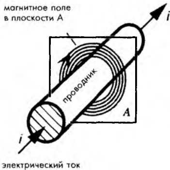
Рис. 3.11 Электрический ток является причиной возникновения магнитного поля вокруг проводника
