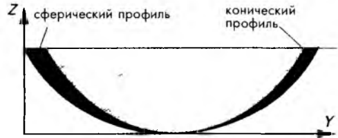
Рис. 4.15. Сравнение профилей сферической и несферической линз
