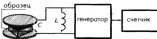
Рис. 13.3. Емкостная система измерения влажности
