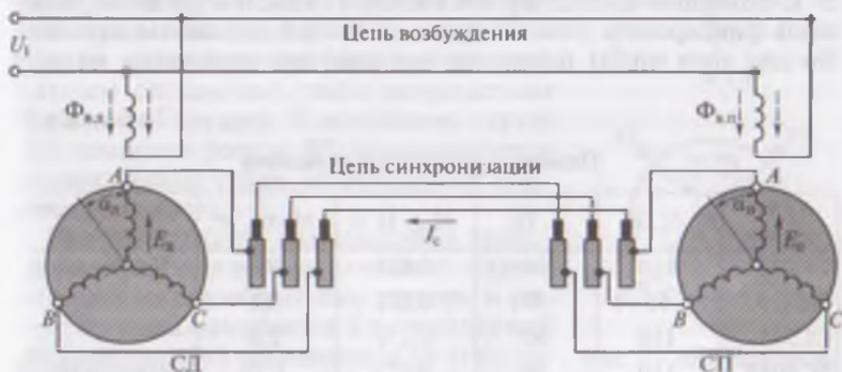
Рис. 7.6. Индикаторная схема синхронной связи
