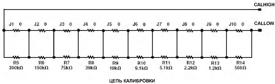
Рис. 44. Принципиальная схема счетчика электроэнергии на микросхеме AD7755, часть 2
