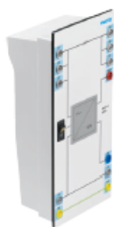
2.2– rasm. O'zgaruvchan kuchlanishni o'zgarmas kuchlanishga o'zgartiruvchi ta'minot blogi.
