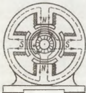
2.2- rasm. To'rt qutbli o'zgarmas tok motorining magnit sistemasi.
