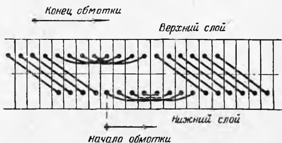
Рис. 13. Торцовая схема укладки обмотки.
