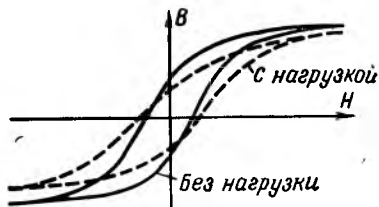
Рис. 19. График изменения намагничивания сердечника при механическом нагружении.
