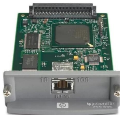
Рисунок - 1.7. Сервер печати HP JetDirect 620N.
