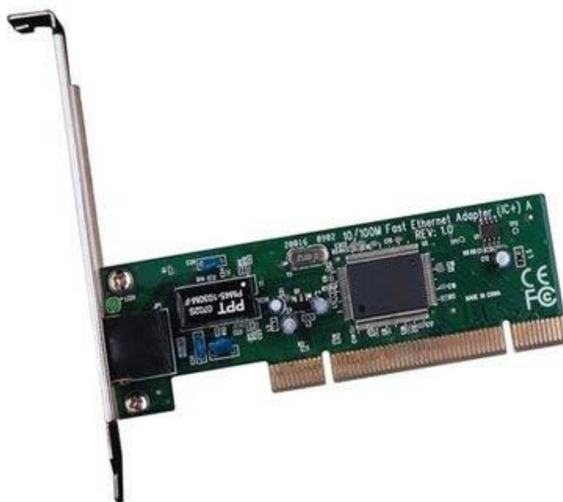
Рисунок - 1.5. Устройство сетевой карты.
