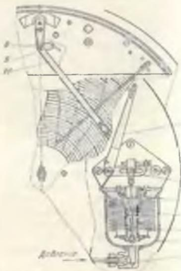
Рис. 7.8. Сильфонный тягонапоромер ТНС-П
