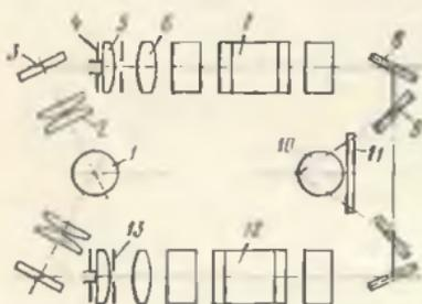
Рис. 11.16. Оптическая схема автоматического колориметра АКН-70
