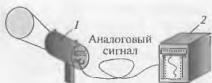
Рис. 8.21. Аналоговая регистрация температуры:
