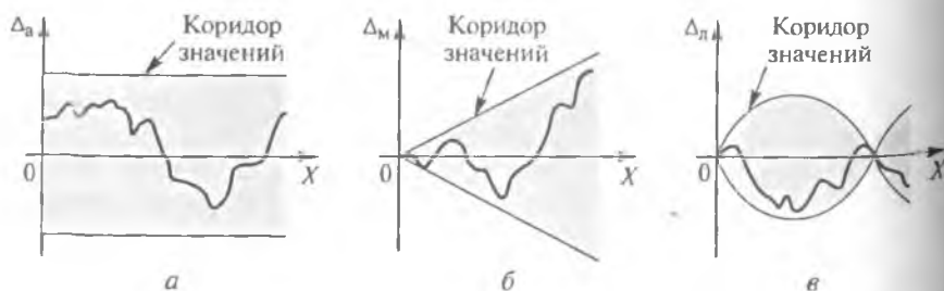
Рис. 1.7. Зависимость погрешностей от значения измеряемой величины X : а — аддитивная погрешность; б — мультипликативная погрешность; в — погрешность линейности
