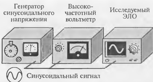
Рис. 4.17. Экспериментальное определение АЧХ канала Y ЭЛО
