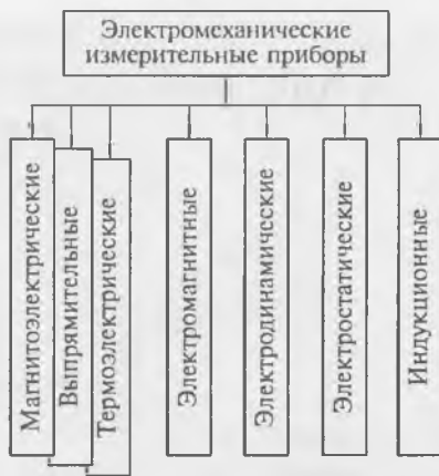
Рис. 3.1. Классификация электромеханических измерительных приборов
