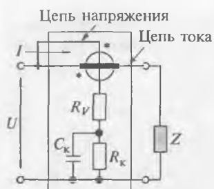
Рис. 3.12. Схема ваттметра электродинамической системы
