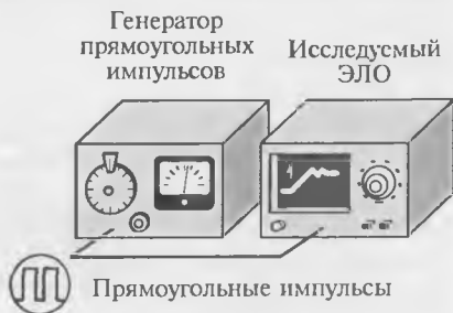
Рис. 4.20. Экспериментальное определение времени нарастания и времени установления канала Y
