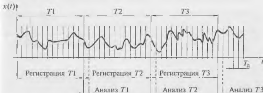
Рис. 7.15. Режим «жесткого» реального времени
