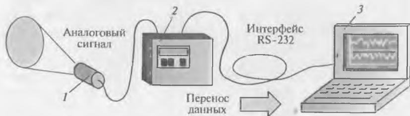
Рис. 8.22. Цифровая регистрация температуры:
