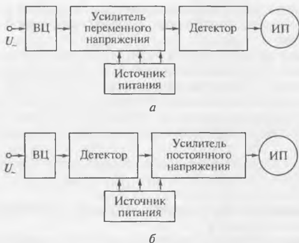
Рис. 3.20. Структуры электронных вольтметров переменного напряжения: a — усилитель—детектор—прибор; б — детектор—усилитель—прибор
