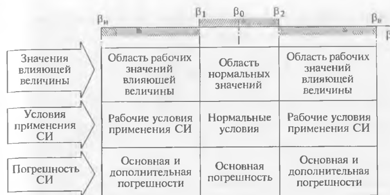
Рис. 1.11. Значения влияющей величины, условия применения и погрешности средств измерений
