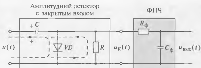
Рис. 3.23. Амплитудный детектор с закрытым входом
