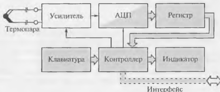
Рис. 8.9. Структура контактного цифрового термометра
