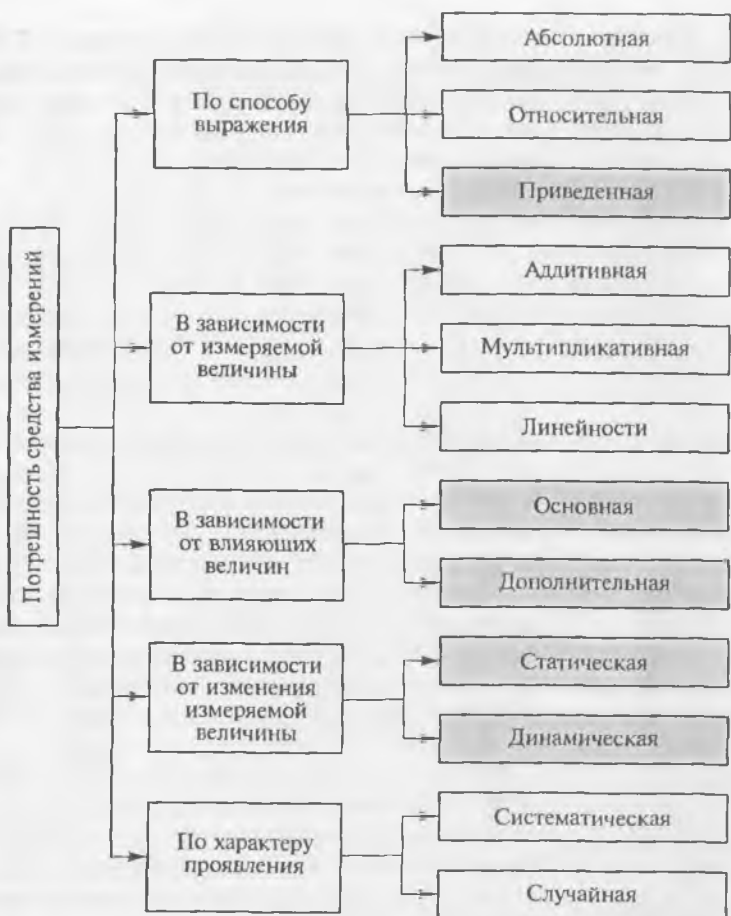
Рис. 1.8. Упрощенная классификация погрешностей средства измерений
