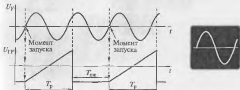
Рис. 4.8. Режим ждущей развертки
