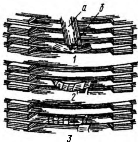
Рис. 20.1. Восстановление витковой изоляции обмотки:
