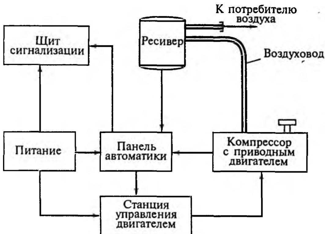
Рис. 1.1. Структурная схема электрооборудования компрессорной станции
