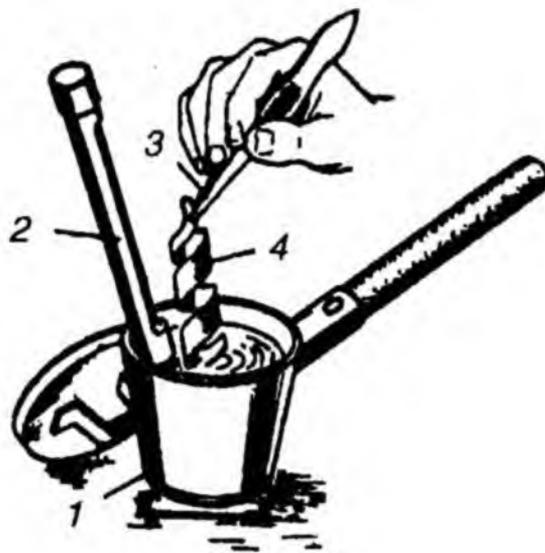
Рис. 7.12. Проверка бумажной изоляции кабеля на влажность:
