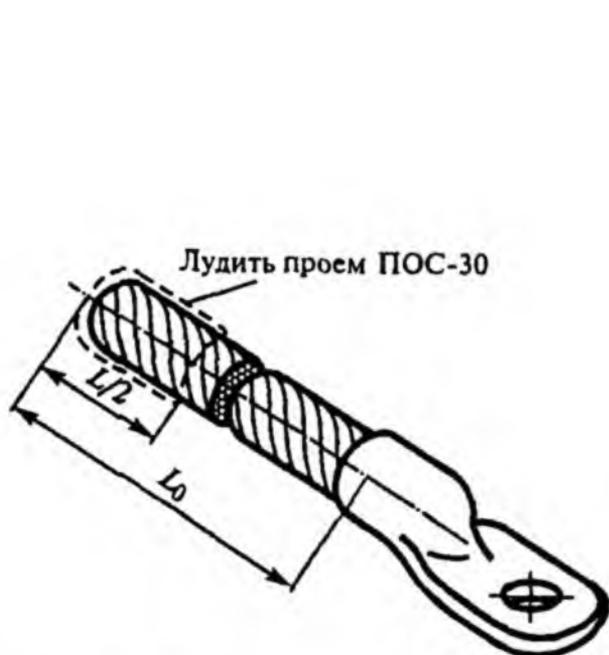
Рис. 1.25. Перемычки гибкие типа ПГМ
