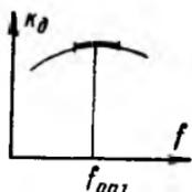
Рис. 3-1. Зависимость коэффициента преобразования датчика от частоты питания.
