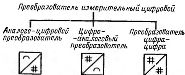
Рис. 140. Преобразователь измерительный цифровой
