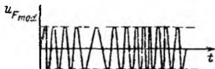
Рис. 218. Частотная модуляция
