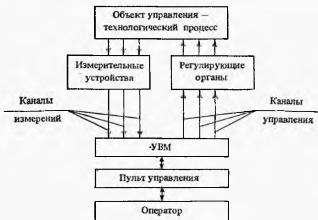
Рис. 158. Упрощенная структурная схема АСУТП.
