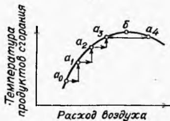
Рис. 140. Автоматический поиск максимума в экстремальной АСР сжигания газа в топке при постоянной статической характеристике объекта.
