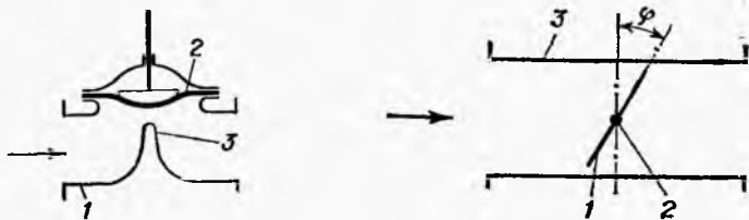
Рис. 129. Диафрагмовый клапан: 1 — корпус; 2 — диафрагма; 3 — перегородка.
