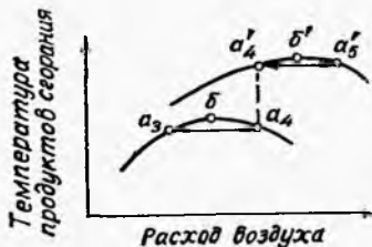
Рис. 140. Автоматический поиск максимума в экстремальной АСР сжигания газа в топке при постоянной статической характеристике объекта.
