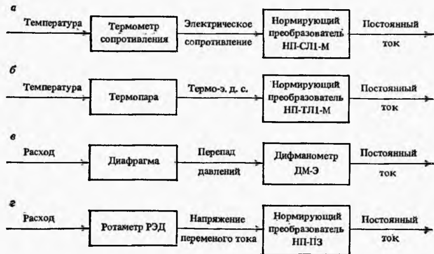
Рис. 125. Примеры измерительных цепей регулятора „Ремиконт“:
