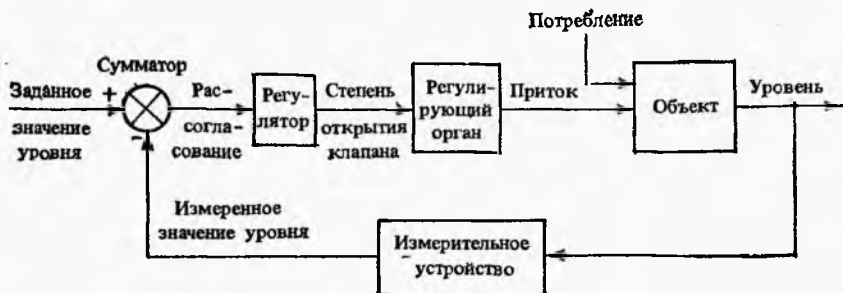
Рис. 4. Структурная схема АСР уровня в емкости.
