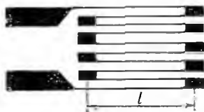
Рис. 16.7. Контур решетки фольгового тензорезистора.
