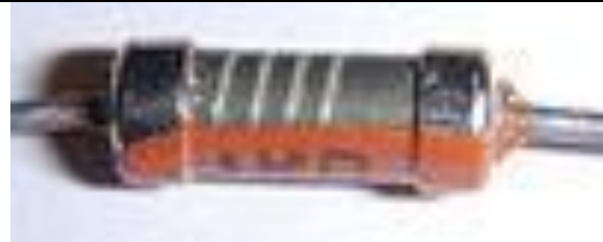
Плёнкали бурчак резистори (ток ўтказувчи юзаси намоиши учун ёпилган ҳимоя қисми олиб ташланган).
