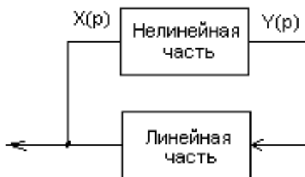
Рисунок 1.6 – Упрощенная структурная схема АСД
