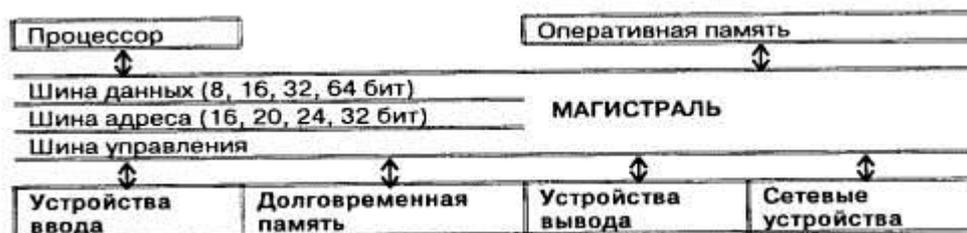
Рисунок 20 - Магистрально-модульное устройство компьютера
