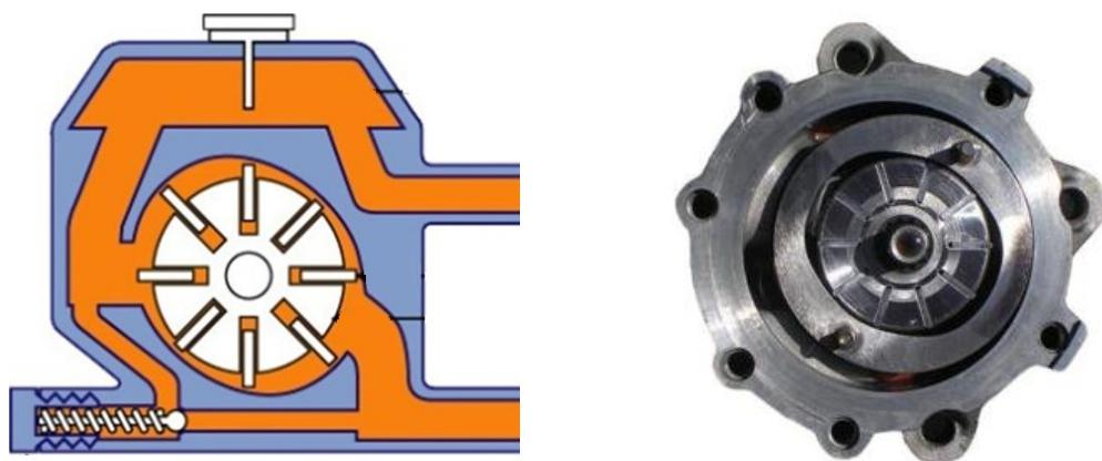
**5.11-rasm. Kurakli nasosning sxemasi va qirqimi**
