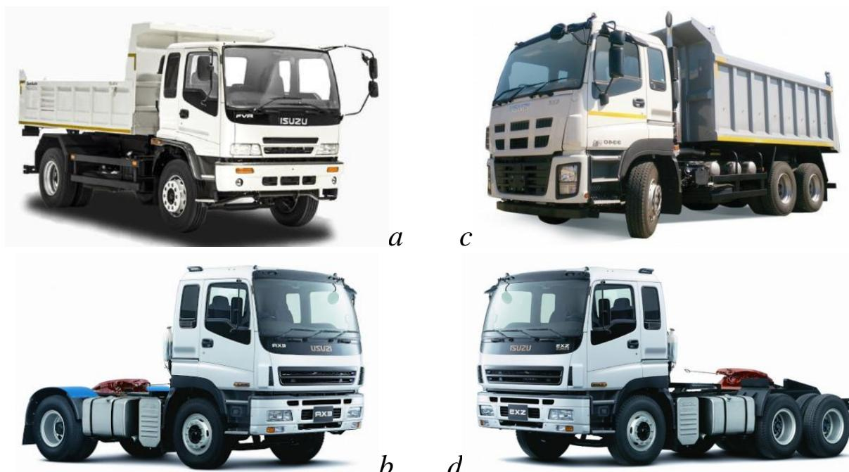
**6.5-rasm. Yuk avtombillari:** *a*-ikki ko‘prikl avtosamosval; *b*-ikki ko‘prikl yuk avtomobili; *c*-uch ko‘prikl avtosamosval; *d*-uch ko‘prikl yuk avtomobili.
