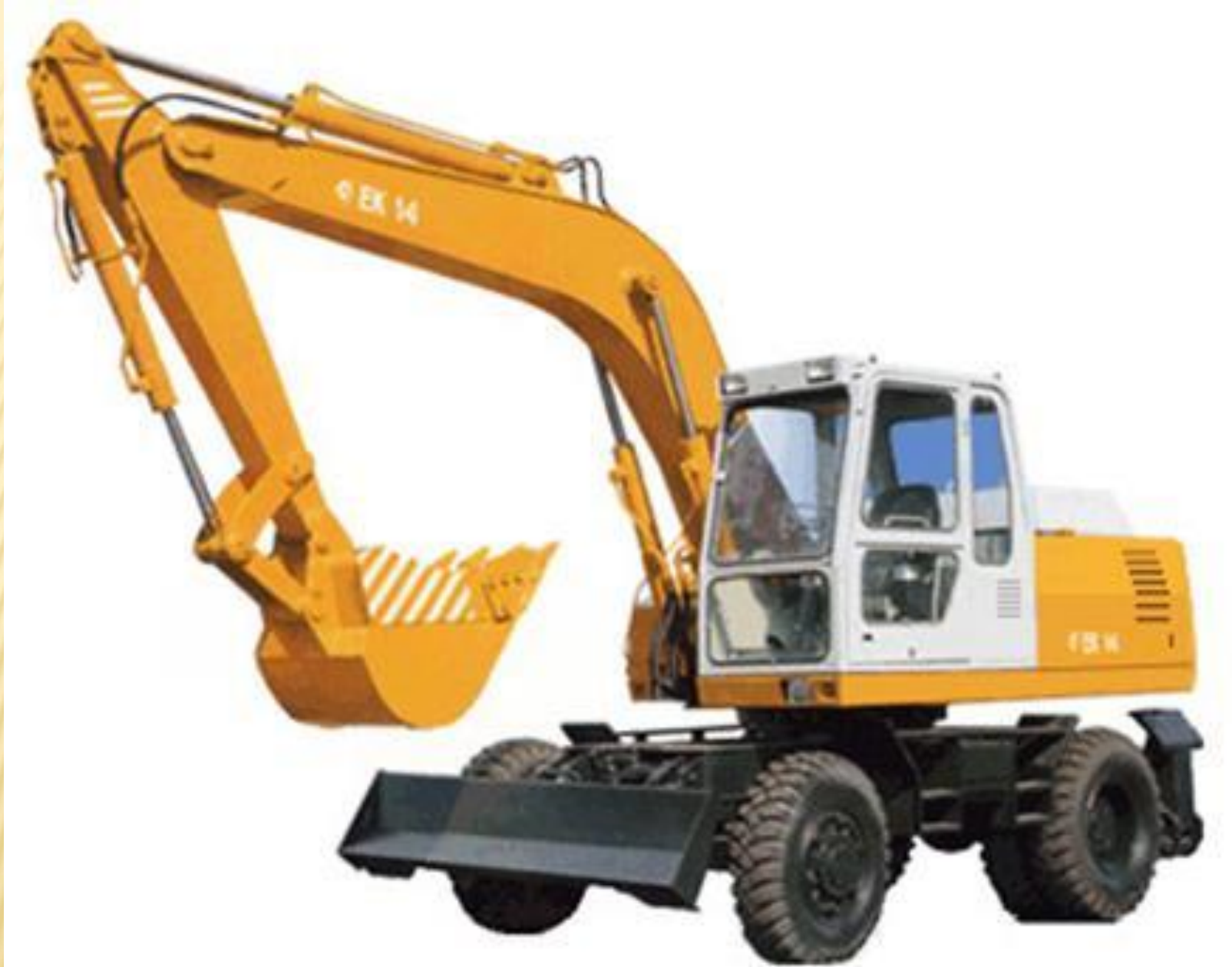
ЕК-14 пневмогиддиракли бир чумичли эксковатор
