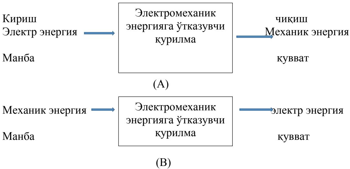
9.1-расм. Электромеханик энергия ўзгартирувчи қурилмаларнинг (А) ва генераторларни (В) функционал блок диаграммаси.
