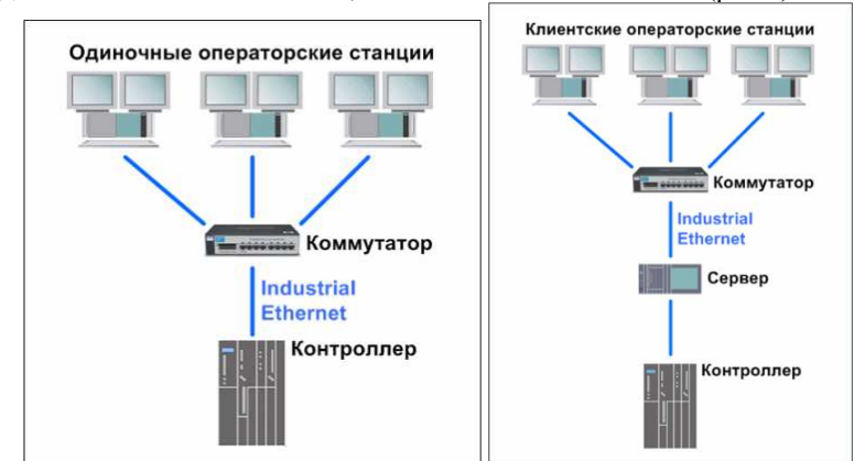
Рис. 1. Схема подключения одиночных операторских станций к уровню управления. Рис. 2. Клиент-серверная архитектура операторского уровня.
