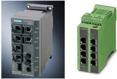
Рис. 1. Промышленные коммутаторы SCALANCE X200 производства Siemens (слева) и LM8TX от Phoenix Contact (справа): монтаж на DIN-рейку; питание от 24 V DC (у SCALANCE X200 возможность резервирования питания); поддержка резервированных сетевых топологий
