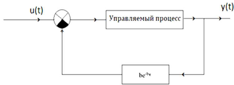
Рис.2.1. Линейная стационарная система n – го порядка с запаздыванием в цепи обратной связи
