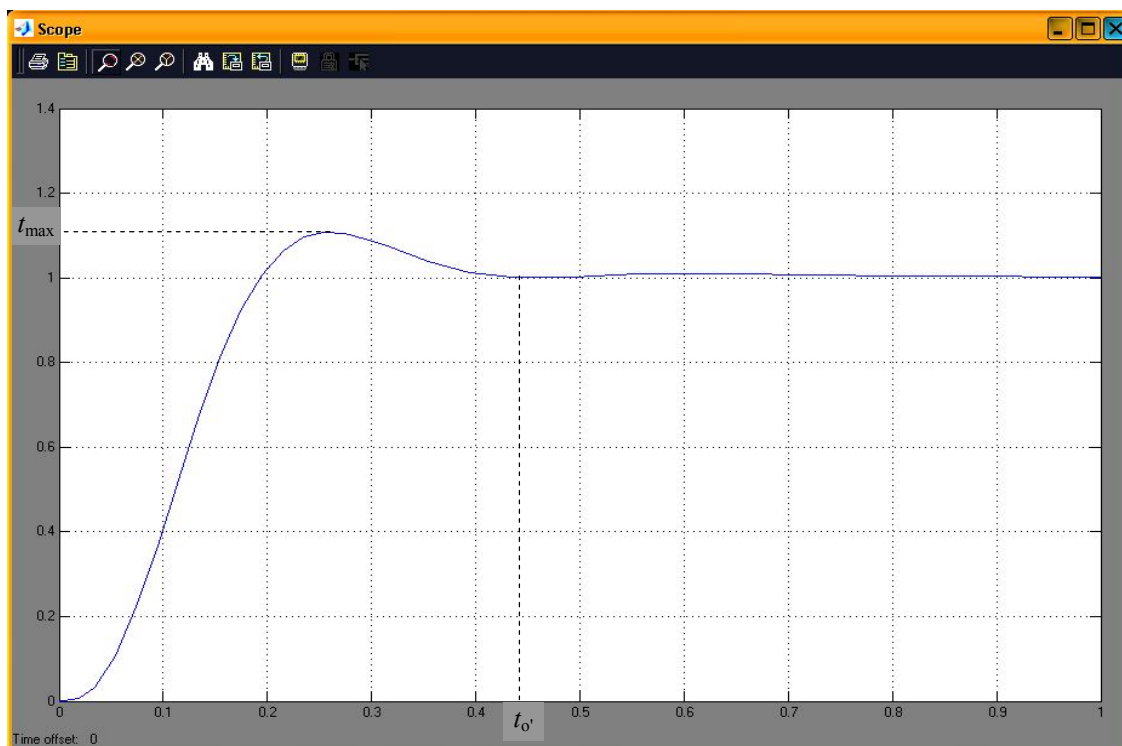
5.14-rasm. Korrektlangan tizimning birlik pog‘onali kirish ta’siridagi o‘tkinchi jarayoni grafigi.
