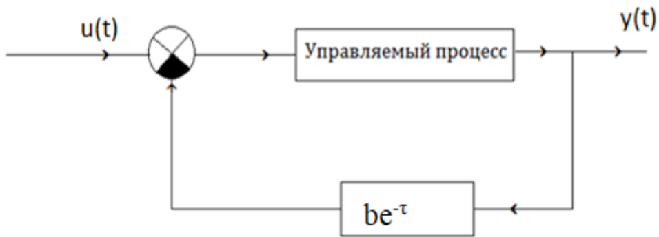
Рис.1.3.1. Линейная стационарная система n – го порядка в запаздыванием в цепи обратной связи
