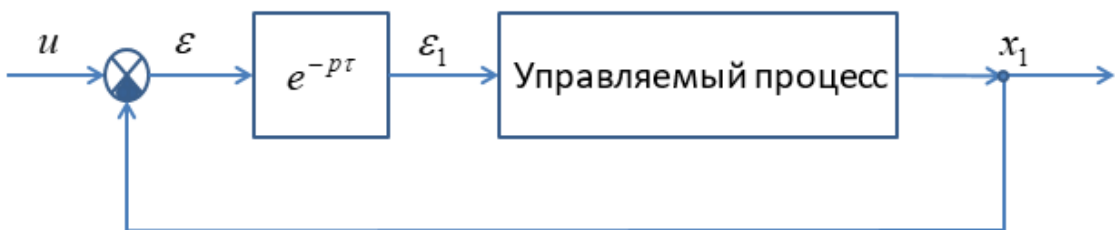
Рис.1.4.5. Свернутая структурная схема системы, представленной уравнением (1.47)
