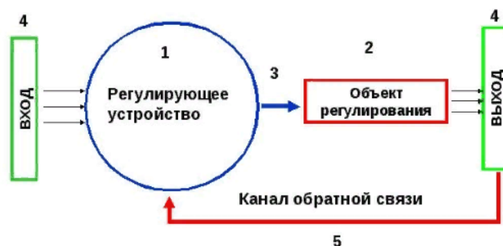
Рис.2.2.1 Модель управления системой с обратной связью
