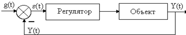
Рис 1.11. Типовая структурная схема САУ по каналу задающего воздействия
