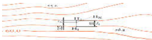
3-расм. Рельеф оралиқдаги баландликларни аниқлаш
