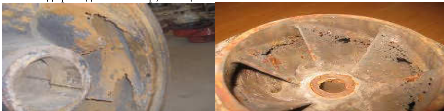
1-расм. Насос ишчи гилдирагининг кавитация натижасида емирилиши.
