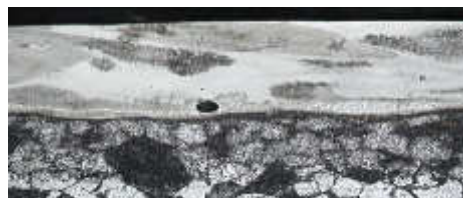
Рис. 1. Микроструктура поверхностного слоя после электроискрового легирования (1 и 3) и последующей лазерной обработки (2, 4). Легирующий электрод ВК8 (1), ОТ4 (3)
