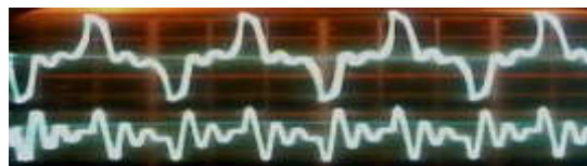
Рис.2. Осциллограмма импульсного (верх.) напряжения и тока разряда в генераторе озона
