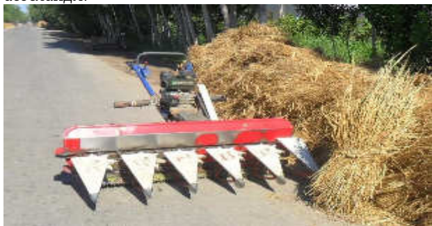
1-расм. Ғалла, беда ва бошқа экинларни ўрадиган кичик ўргич
