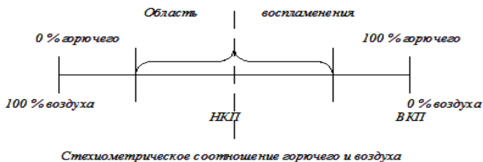
Рис. 1. Схема концентрационных пределов распространения пламени.
