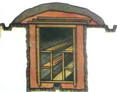
Перекрытая землянка грунтом тол. щелью в 1 м ослабляет дозу радиации в 100 раз.
