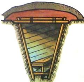
Перекрытые щели ослабляют дозу радиации в 21-30 раз.
