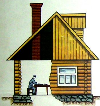
Одноэтажный деревянный дом ослабляет дозу радиации в 3 раза.
