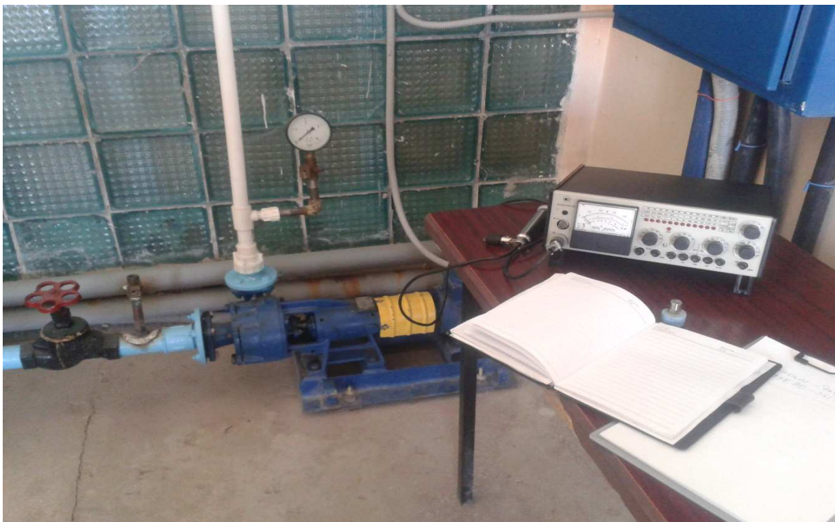
1-расм. Турли режимда ишлаётган насосда содир бўладиган титрашларни аниқлаш стенди.
