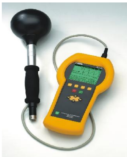
2.3-rasm. Elektr va magnit maydon kuchlanganligini o'lchovchi kichik chastotali asbob ( . 42).
