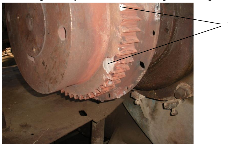
15.4-rasm. Muvozanatning buzilishi tufayli kuch uzatish tizimidagi shikastlanish. 1-nasosni biriktirish muftasi tishlarining sinish holati.
