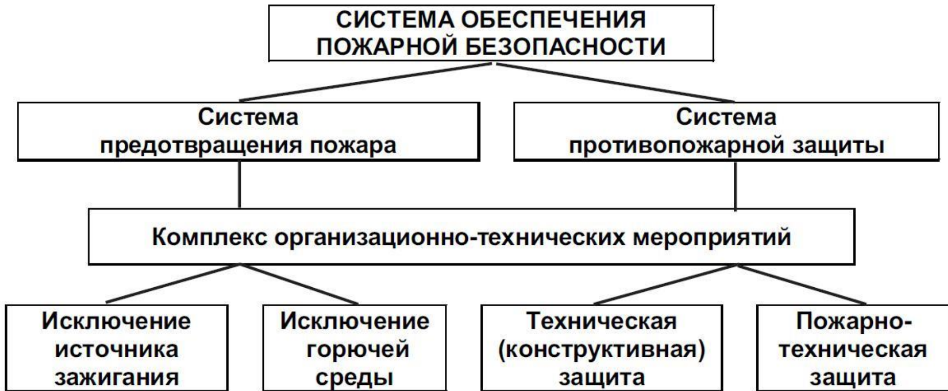
Рис. Система обеспечения пожарной безопасности объекта защиты
