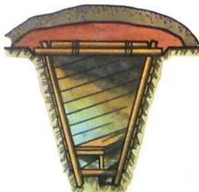
Перекрытые щели ослабляют дозу радиации в 21-30 раз.
