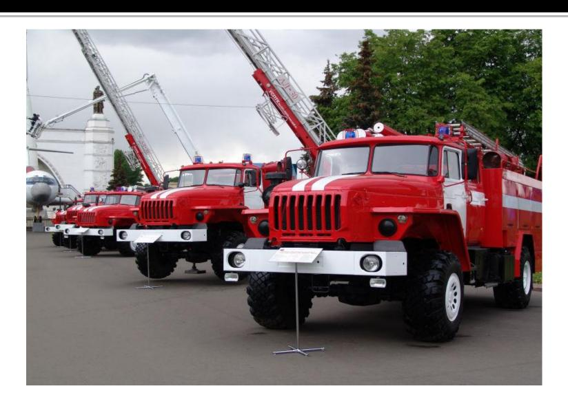
Если же ее сил не хватает, тогда в работу вступают автонасосы. Они не вывозят воду, они вывозят большой запас рукавов и немного пенообразователя.
