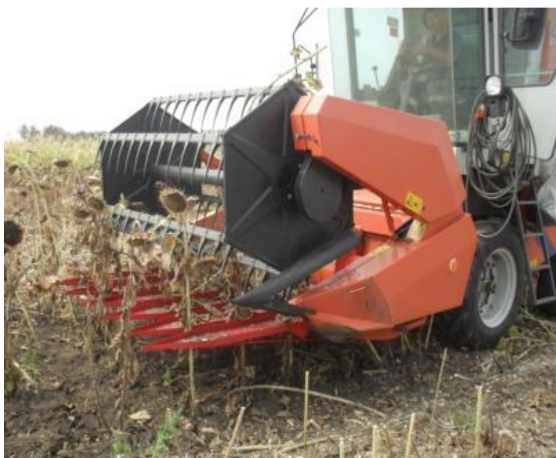
Рисунок 3 - Уборка учетных делянок переоборудованной жаткой селекционного комбайна
