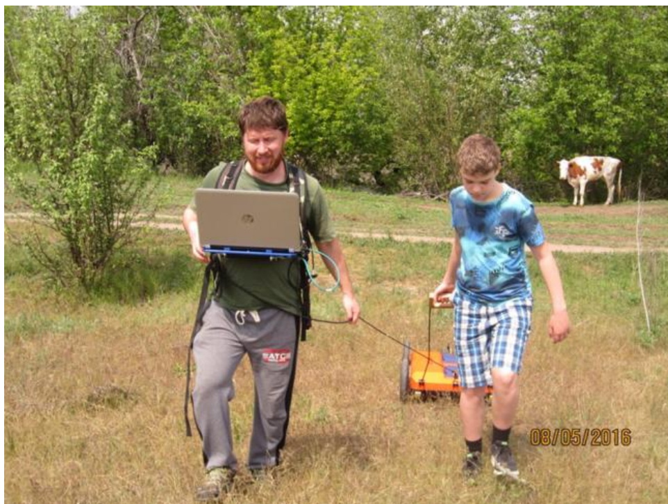
Рисунок 1. Геофизическое профилирование лугов в северной части Волго-Ахтубинской поймы с использованием георадара «ОКО-2».
