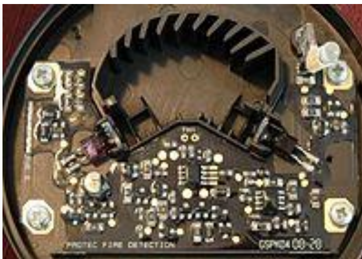
Рис. 21 Дымовая камера и электроника точечного дымового извещателя
