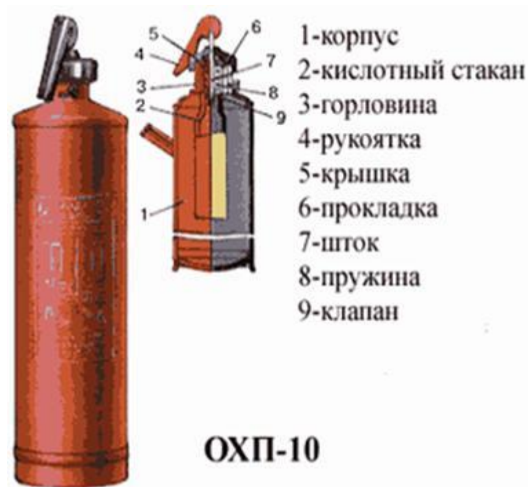
Рис 8.2 ХИМИЧЕСКИЙ ПЕННЫЙ ОГнетушитель ОХП-10. 1-корпус, 2- стакан с кислотой, 3-боковая рукоять, 4-головка, 5-рукоять, 6-ш, 7-крышка, 8-пульверизатор, 9-клапан, 10-предохранитель, 11-нижняя рукоять.
