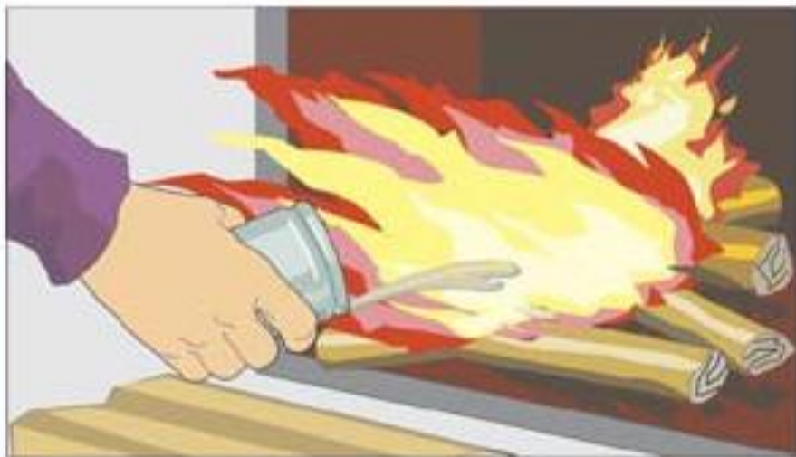
Применение для розжига печей легковоспламеняющихся и горючих жидкостей, выпадение углей, трещины в кладке, возгорание сажи в дымоходах
