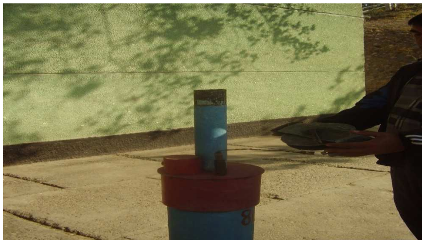
3–расм. Каркидон сув омборидаги сизот сувларини ўлчаш асбоби (пьезометр).
