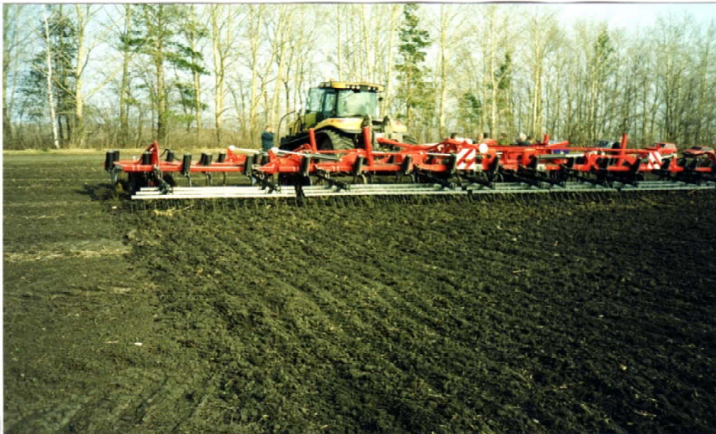
Рис.1г. Культиватор «Horsch» оставляет за собой глыбистую, гребнистую (до 11см.) поверхность, недопустимую по агротехнике возделывания зерновых культур в России и за несколько дней удаляет запасы влаги и тепла в почве как радиаторная поверхность, что приводит к резкому снижению урожайности
