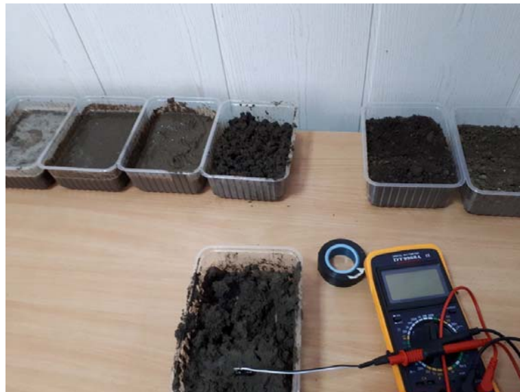
Рисунок 4 – Составление шкалы влажности почвы и подключение датчика к омметру и запись выходного сигнала датчика при различных уровнях влажности почвы
