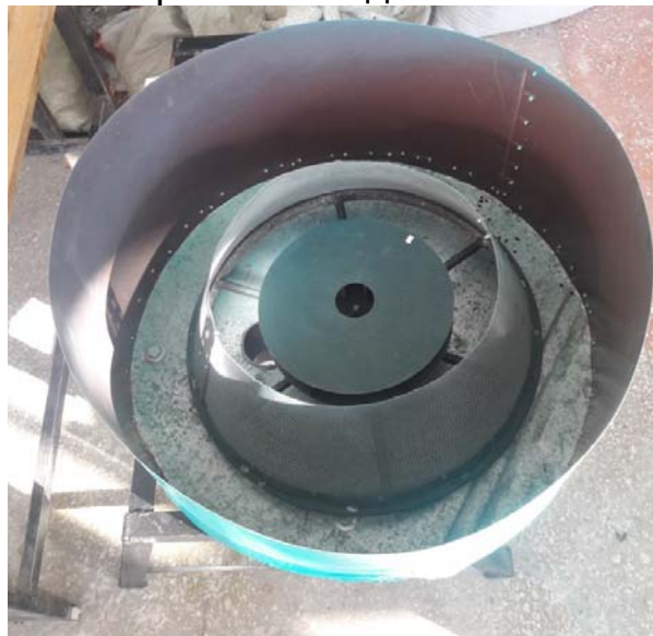
Рисунок 3 – Устройство для шелушения зерна гречихи с вариативной декой без крышки
