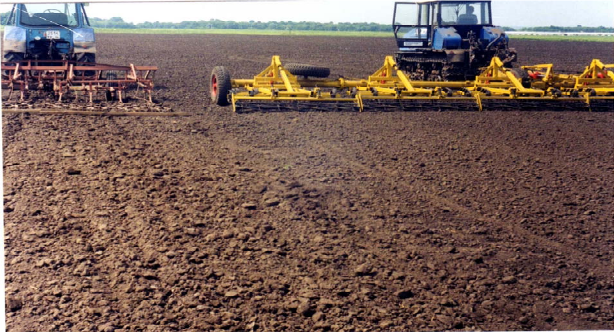
Рис.1в – Культиватор КБМ обеспечивает стопроцентное выравнивание поверхности поля (справа). Общепринятый по всей России культиватор КПС-4+4БЗСС-1+шлейфы не обеспечивает условий сохранения влаги, гребнистость – 7 см, равномерной заделки семян, их дружной всхожести, образования вторичных корней и кущения, допустив потерю половины потенциального урожая (слева). Таким же и более недостатком обладает зарубежный аналог – культиватор «Horsch»
