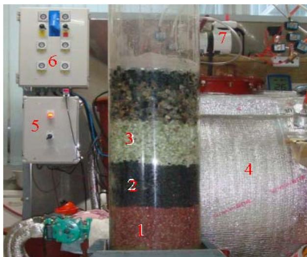
1,2,3 –кассеты для очистки биогаза; 4-многофункциональная лабораторная биогазовая установка (рабочий объем 960 литров); 5-пульт управления БГУ; 6-вакуум контроль давления биогаза в системе очистки и биореактора
