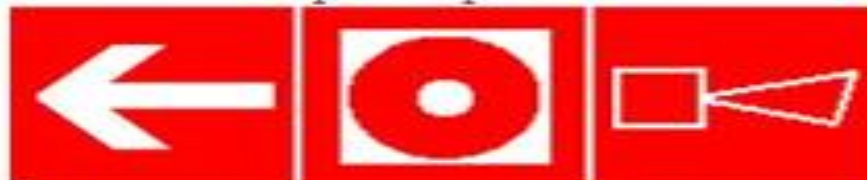
Кнопка включения установок пожарной автоматики и оповещателей налево
