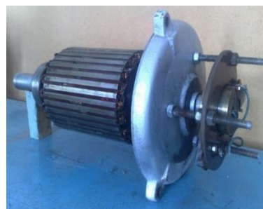
1.2 расм. Қўзғатув чулғамини таъминлайдиган чўткали механизмга эга бўлган даврий импульс кучланишли машина генераторини ротори
