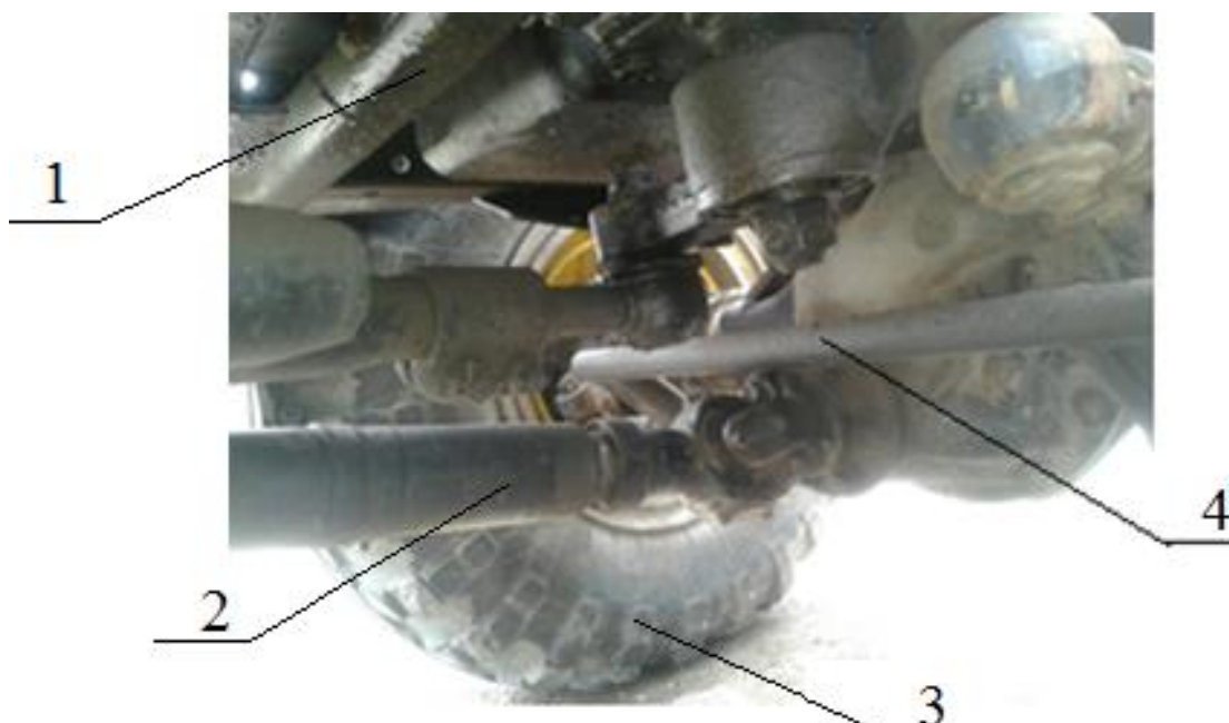
1.3 – расм. Тажриба – синов тракторида қўндаланг турғунликни таъминловчи стабилизаторнинг жойлашиши: 1-рама; 2-кардан узатмаси; 3- ғилдрак; 4 – бўйлама тиргак.
