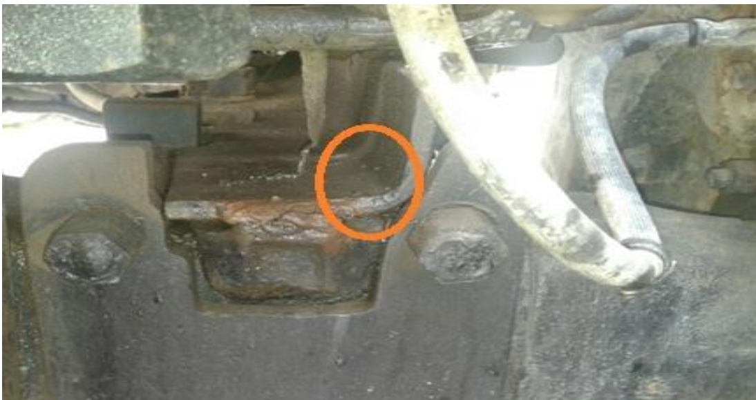
1.4-расм. Тажриба - синов тракторининг тажрибалар давомида аниқланган дефектли қисми.
