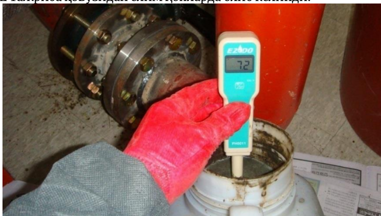
1-расм. Дастлабки ишлов беришда биореакторга солиш учун тайёрланган органик чиқинди таркибидаги рН миқдорини ўлчаш
