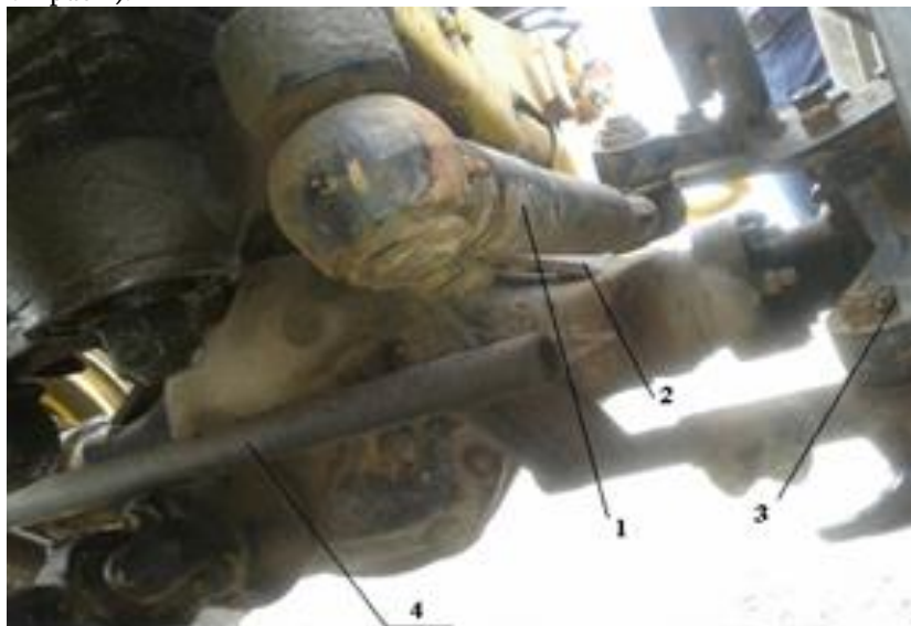
1.2-расм. Тажриба – синов тракторида демпфер қурилмасининг жойлашиши: 1-бўйлама тяга; 2-кўндаланг тряга; 3-тутуб туриш гайкаси; 4-кўндаланг тяга;
